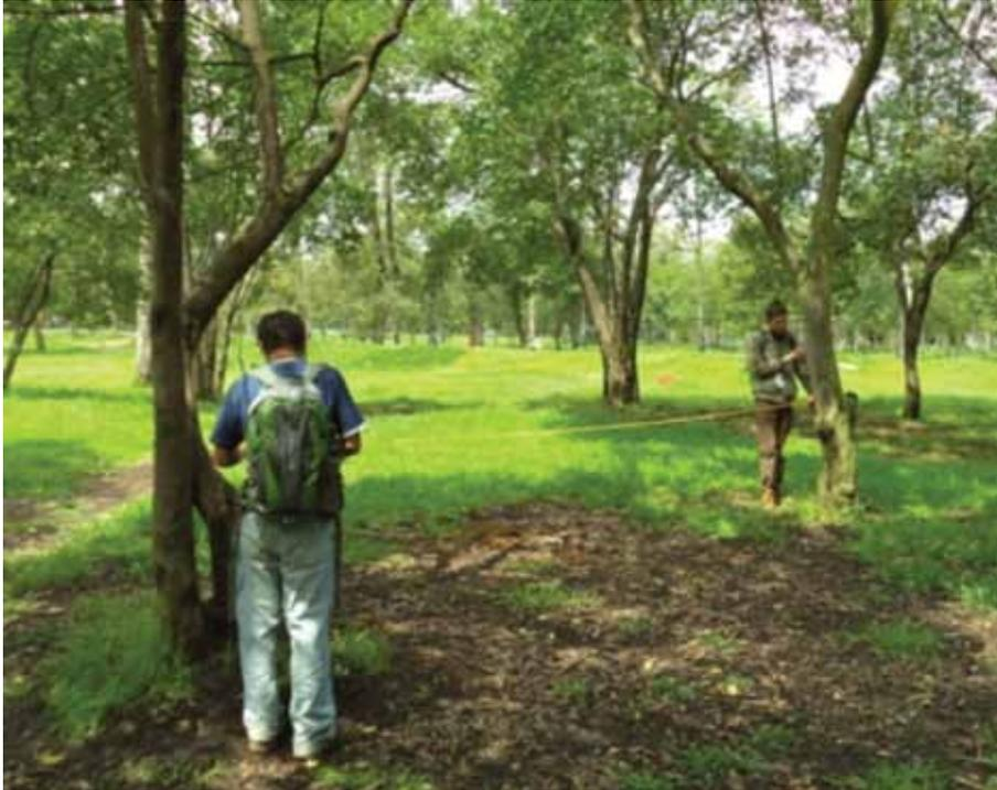
Figura 23.- Ubicación de un sitio de muestreo y medición del radio de 12.62 m.
